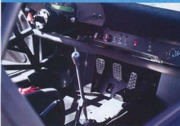
Erreichbarkeit verbessert: Der Präzisions-Schalthebel ist höher positioniert und somit dem (abnehmbaren Lenkrad) nähergerückt, zudem sind die Schaltwege verkürzt worden
