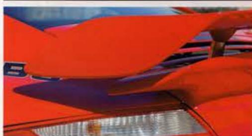
Kantiger ausgeformt, weiter nach hinten versetzt: Heckflügelblatt auf ausgefahrenen Stützen
