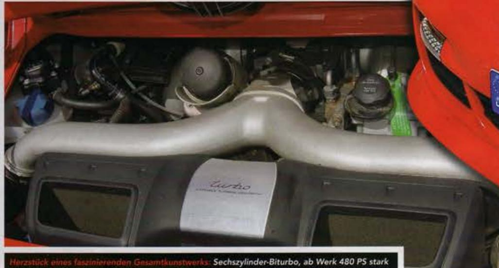
**Herzstück eines faszinierenden Gesamtkunstwerks:** Sechszylinder-Biturbo, ab Werk 480 PS stark
