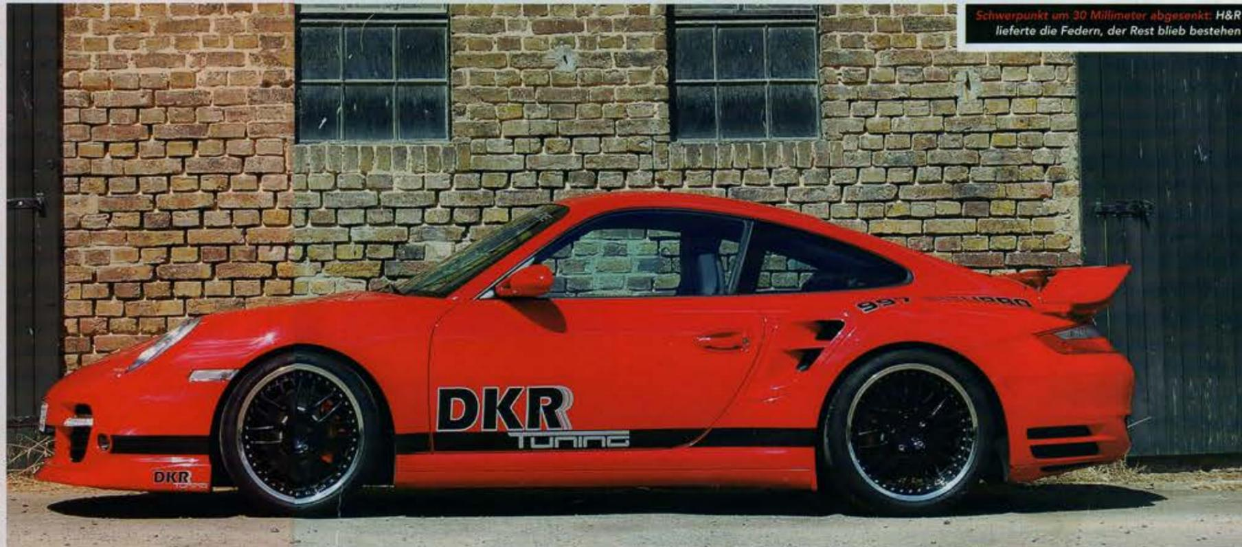
Schwerpunkt um 30 Millimeter abgesenkt: H&R lieferte die Federn, der Rest blieb bestehen
