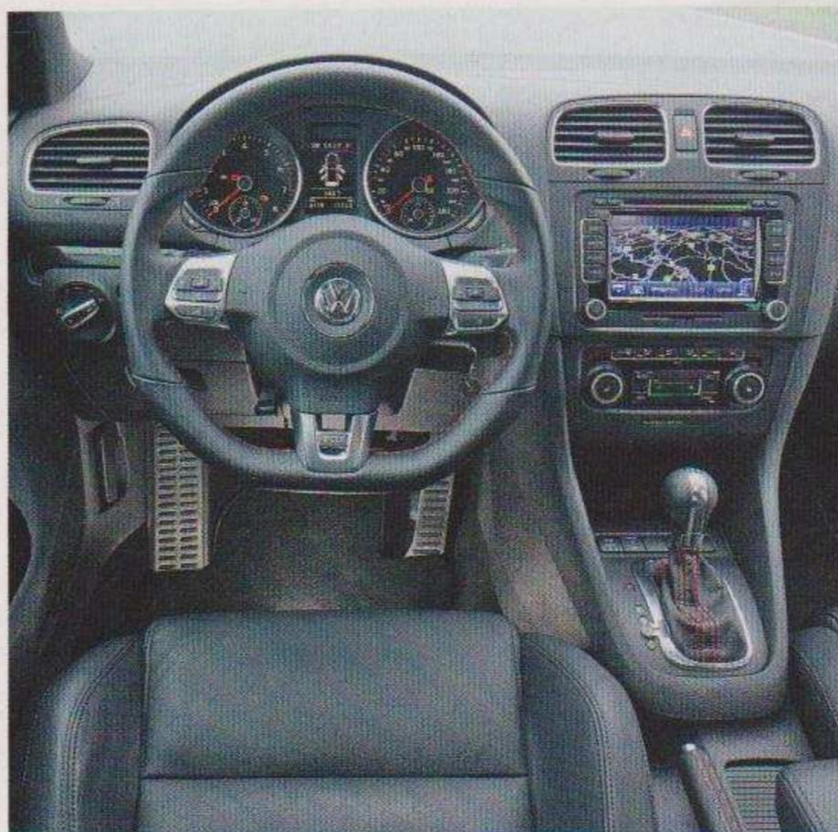
Reine Serie: klar gegliederte Instrumente, griffiges, unten abgeflachtes GTI-Lenkrad, DSG-Wählhebel - alles in tadelloser VW-Verarbeitungsqualität
