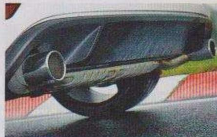
Sieht aus wie vom Tuner, ist aber Serie: Heckdiffusor mit zwei Endrohren
