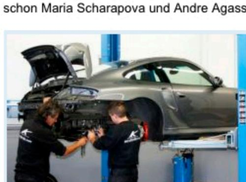
Mittels neuem Turbolader und neuer Auspuffanlage sowie einer Softwareanpassung wird hier ein Porsche von 420 PS auf 600 PS „optimiert“. Foto: Rudolph Greuel/pp/Agentur ProfiPress
